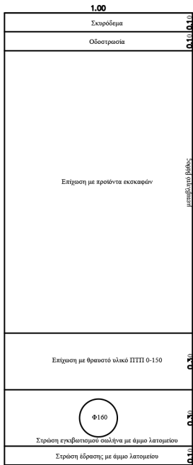
Τυπική διατομή Β (σκυρόδεμα)
