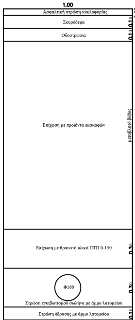
Τυπική διατομή Γ (άσφαλτος - σκυρόδεμα)
