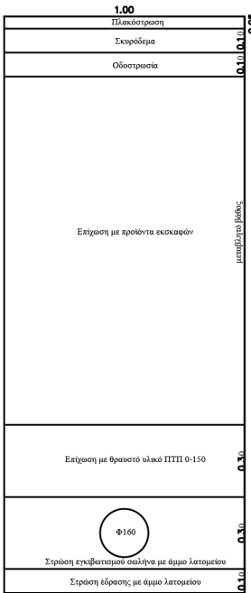
Τυπική διατομή Δ (πλακόστρωση)
